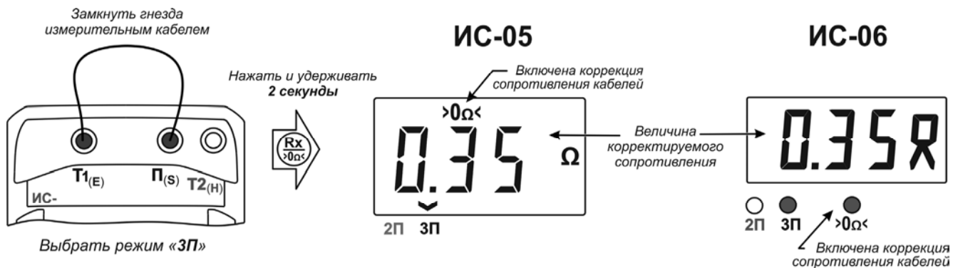
Рисунок 3 – Коррекция сопротивления измерительного кабеля (3П)
