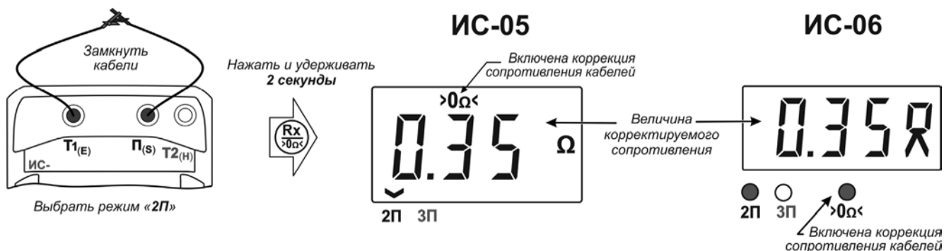
Рисунок 4 – Коррекция сопротивления измерительных кабелей (2П)
