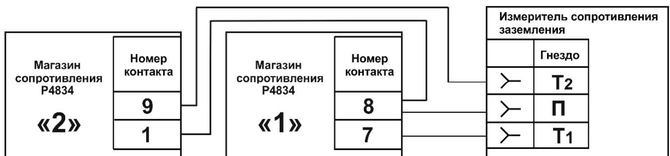
Рисунок 6.6.2 – Схема подключения при опробовании !
